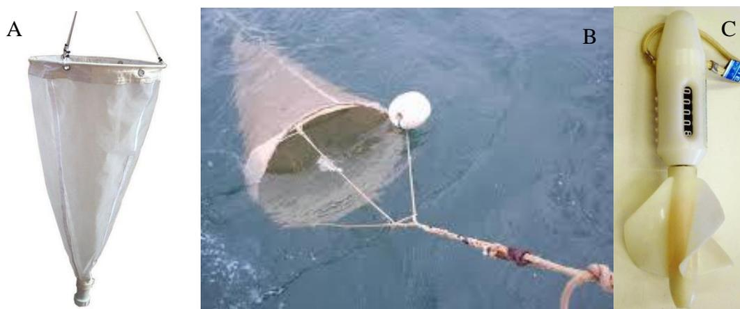
**Figura 8.** Rede de plâncton (A) rede e copo de recolha (B) rede em utilização com indicação da direcção da corrente (C) fluxómetro, instrumento que pode ser fixado à rede para quantificação do volume filtrado
