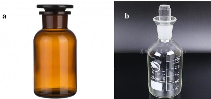
**Figura 4.** Frasco de Winkler (a) para colheita e armazenamento de amostra de água para determinação de oxigénio e exemplo de frasco similar alternativo (b).
