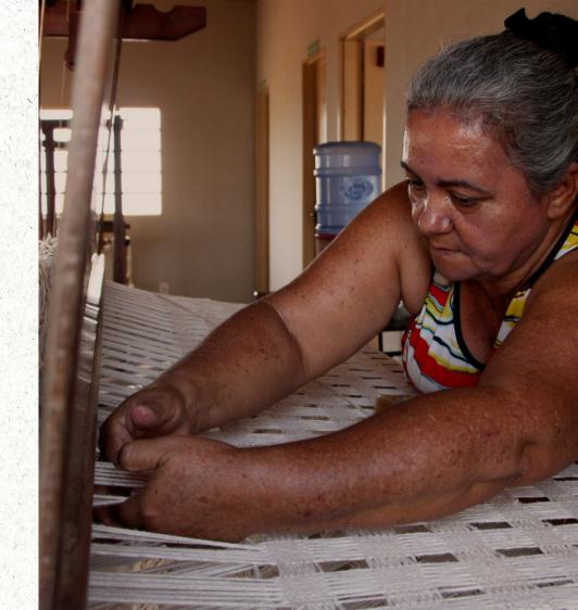
A fase sequinte, no urdume, envolve diversas etapas necessárias antes de se iniciar o processo de tramagem, como a confecção do urdume, quando os fios são dispostos paralelamente no tear, passados pelos liços e dentes do pente. Essas operações são realizadas a partir de uma série de combinações de acordo com a peça a serem elaboradas.
