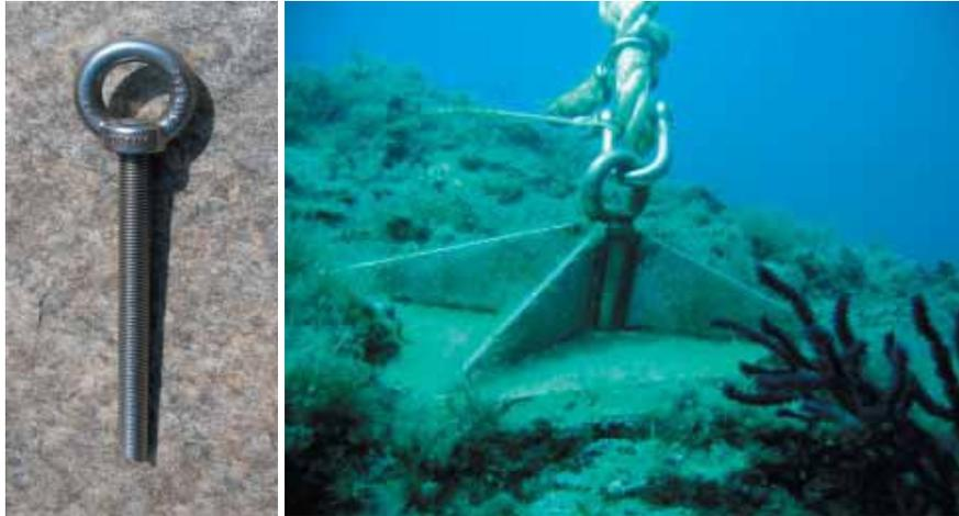
Figure 8 : Les scellements d'ancrages (Francour et al., 2006)
