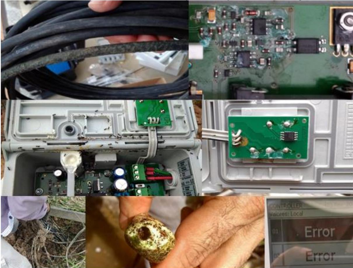
**Figura 12:** Detalhes de avarias ocorridas nos equipamentos da REMAPP, entre elas degradação do cabeamento, infestação por insetos, oxidação nos contatos dos Data loggers e biofilme nos sensores que demandam frequente limpeza e calibração.
