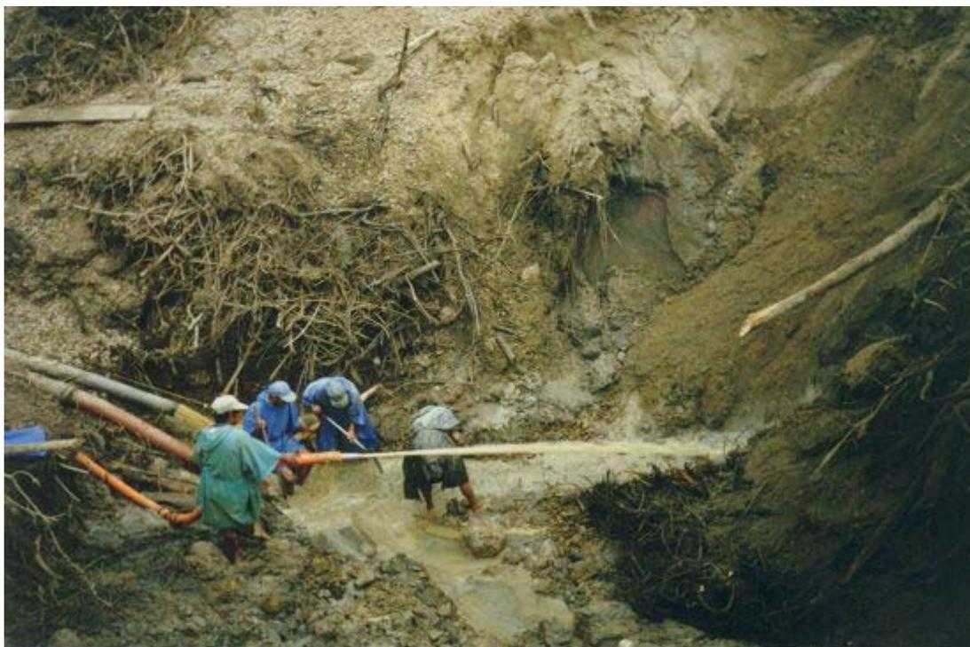
**Figura 18:** Explotación por arrastre con el uso de monitores (Foto A. Trillo)
