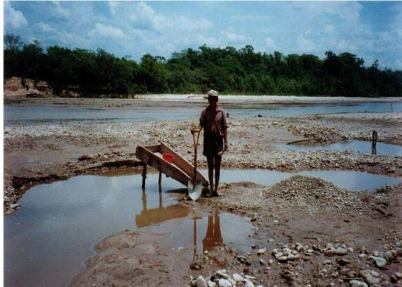
**Figura 14:** Explotación artesanal de áridos en pozas a orillas del río Surutú (Foto R. Cortéz, A. Cruz)
