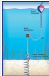
La ligne de mouillage est un dispositif situant entre un objet ou une structure et un point d'ancrage fixe (rocher, rochers). Elle présente les éléments suivants :
